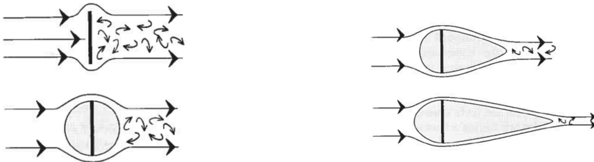
Bild 3 visar laminärt och turbulent flöde kring olika formade föremål med samma frontal area.
